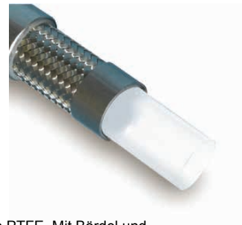
PTFE-Wellenschlauch mit umgebördelten Enden. Medienberührung; rein PTFE. Mit Bördel und Losflansch aus Edelstahl.
