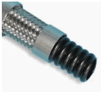
PTFE-Wellenschlauch mit umgebördelten Enden. Medienberührung; rein PTFE. Mit Bördel und Losflansch aus Edelstahl.
