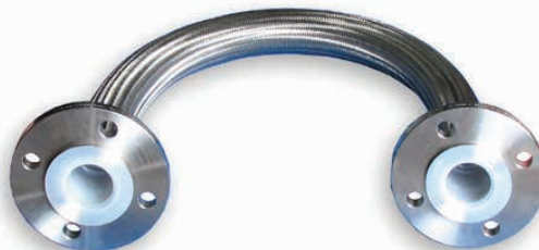
PTFE-Wellenschlauch mit umgebördelten Enden. Medienberührung; rein PTFE. Mit Bördel und Losflansch aus Edelstahl.
